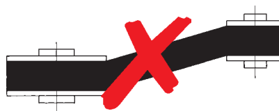
Défaut d'alignement des poulies
